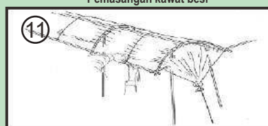
Pemasangan tali penguat dan penjepit plastik
