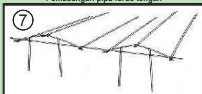
Pemasangan pipa penguat
