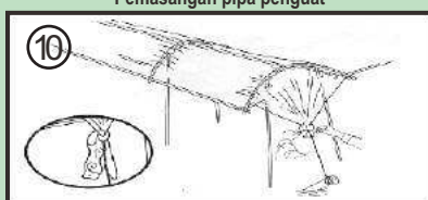
Pemasangan plastik penutup
